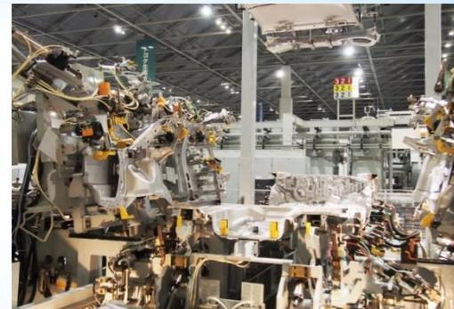
ベルトコンベアで流しながら自由な角度からの溶接が必要な自動車車体...など
