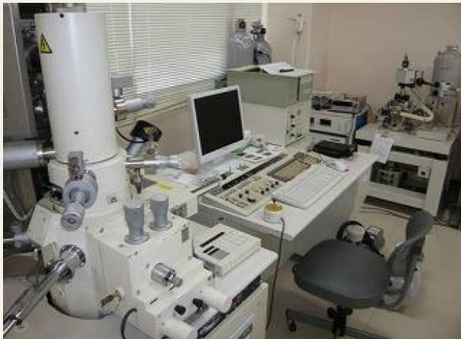
原理：試料に電子線を走査させて結像する
