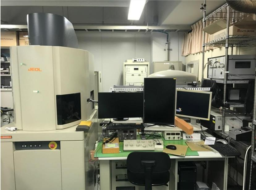
原理：試料に電子線を透過させて結像する
