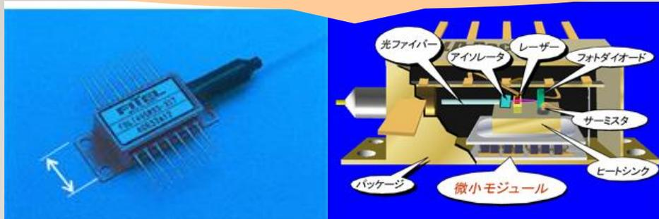
静謐で無振動、温度の微調整が可能なことを利用した冷却用途に用いられている
