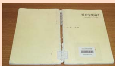
背の接着剤が割れたもの
