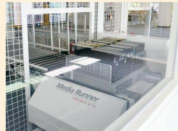
自動書庫から受け取り場所までの距離は約50m。全国の自動書庫の中でも最長クラスです。その長い距離を迅速に運ぶため、本学特別仕様様の「高速移動台車」(左写真)にコンテナを載せ、毎分200mの速さで運搬しています。
